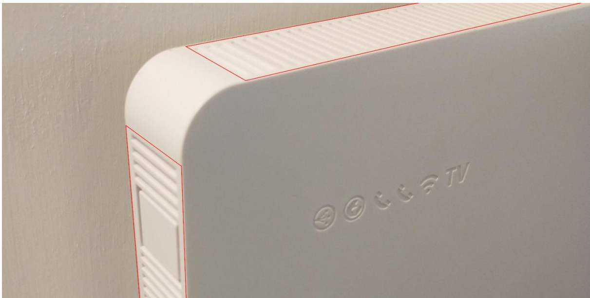
Figur 5 Markerat i rött är de öppningarna som kan behöva dammsugas.
