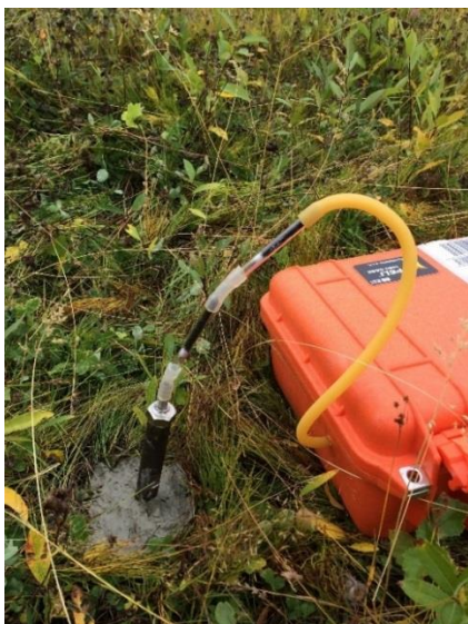
Figur 4. Färdig ihopkopplad utrustning för mätning av porgas.
